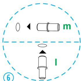
6 Coloque en pieza 14, 4 herrajes **l** como se indica. Coloque en piezas 04 y 05, 8 herrajes **m** y sobre estos las piezas 06.
