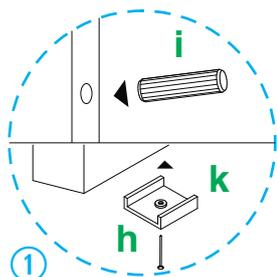
1 Coloque en las piezas 15 y 16 2 herrajes **i** como se indica. Coloque en piezas 03 y 04 2 herrajes **k** y 1 herraje **k** en piezas 15 y 16 como se indica, fíjelos con herrajes **h**.
