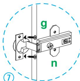
7 Posicione las piezas 11 en la pieza 04 y 05 fijando los herrajes **n** con 2 herrajes **g** cada uno. Repita colocando las piezas 10 en piezas 03 y 05.
