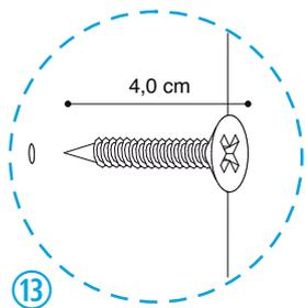
Fije con 4 **Tornillos** la pieza **Puntera cajón**, al ensamble anterior.
