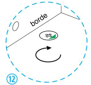
Posicione las piezas **Costado cajón** sobre la pieza **Frente Cajón** y gire las **Tuercas minifix** hasta que la flecha señale el sentido opuesto.
