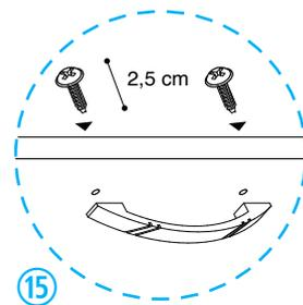
Coloque en la pieza **Frente cajón** una **Manija** con 2 **Tornillos**. Repita el armado para todos los cajones y colóquelos en el mueble.
