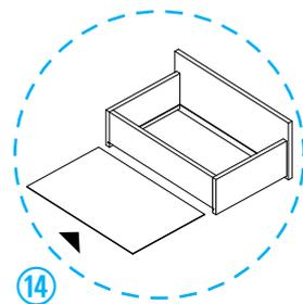
Deslice entre las ranuras la pieza **Fondo cajón** hasta hacer tope y únala a la pieza **Puntera cajón** mediante **Clavos**.
