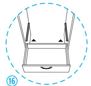
Coloque los cajones en el mueble utilizando las guías y las ranuras de las piezas **Costado cajón** como se indica.
