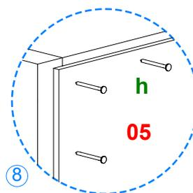
Ponga el mueble boca abajo y corrobore que quede en perfecta escuadra. Proceda a clavar la pieza **05** al mueble mediante los herrajes **h**.
