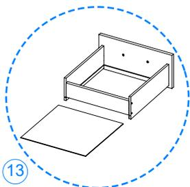
13 Deslice entre las ranuras la pieza **04** hasta hacer tope y únala a la pieza **07** mediante herrajes **h**.
