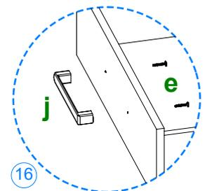
16 Coloque en la pieza **06** el herraje **j** con 2 herrajes **e**. Repita el armado para todos los cajones y colóquelos en mueble.
