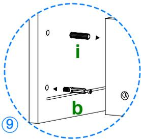
9 Coloque la pieza **06** sobre el piso y atornille 2 herrajes **b**. Como se indica.
