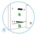
Coloque la pieza 13 sobre el piso y atornille 2 herrajes b.
