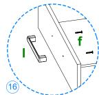
Coloque en la pieza 13 el herraje I con 2 herrajes f. Repita el armado para todos los cajones y colóquelos en mueble.
