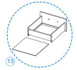
Deslice entre las ranuras la pieza 09 hasta hacer tope y únala a la pieza 16 mediante herrajes j.
