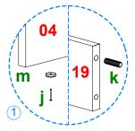
Coloque en las piezas 19 2 herrajes k como se indica. Coloque en la parte inferior de las
