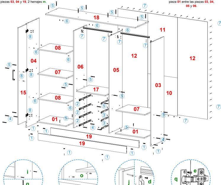
Atornille por arriba de la pieza 18 a las piezas 03, 04, 05 y 06 con 8 herrajes i. Atornille con 4 herrajes i la pieza 17 entre la pieza 05 y 06, y las piezas 07 entre las piezas 03, 04, 05 y 06.
