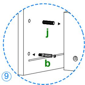
Coloque en la pieza **10** sobre el piso y atornille 2 herrajes **b**. Coloque 1 herraje **j** en cada pieza **02** como se indica.
