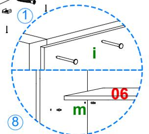
8 Coloque en piezas 04 y 05 2 herrajes m en cada una y sobre estos la pieza 06. Ponga el mueble boca abajo y corrobore que quede en perfecta escuadra. Proceda a clavar las piezas 07 y 08 al mueble con los herrajes i y atornille a pieza 15 trasera con 5 herrajes c.
