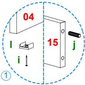
1 Coloque en pieza 15 2 herrajes j. Coloque en las piezas 03 y 04 2 herrajes i y 1 herraje i en pieza 15 delantera.
