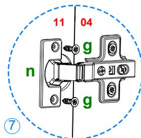
7 Posicione la pieza 11 en la pieza 04, fijando 2 herrajes n con 4 herrajes g cada uno. Coloque en la pieza 11 una manija de herrajes p y k con 2 herrajes e.
