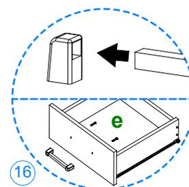
Arme las manijas con 2 herrajes **k** y un herraje **o**. Coloque en la pieza **10** la manija con 2 herrajes **e**. Repita el armado para todos los cajones y colóquelos en el mueble.
