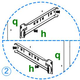
2 Fije con 2 herrajes h cada una de las 4 correderas hembra q marcadas con una L en pieza 05. Fije con 2 herrajes h cada una de las correderas hembra q marcadas con una R en pieza 03.
