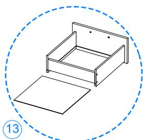
Deslice entre las ranuras la pieza **09** hasta hacer tope y únala a la pieza **12** mediante herrajes **i**.
