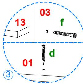
3 Atornille las piezas 15 con 4 herrajes f entre las piezas 03 y 04. Atornille la pieza 13 con 4 herrajes f entre las piezas 03 y 05. Atornille la pieza 01 entre las piezas 04 y 05 con 4 herrajes f y a las piezas 15 con 2 herrajes d.
