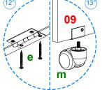
Posicione la pieza 01 con la pieza 06 y atornille el herraje s con 2 herrajes e como se indica. Coloque 1 herraje m en la parte inferior de las piezas 09 y 10.
