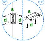
Posicione la pieza 10 con la pieza 09 y atornille los herrajes s con 4 herrajes d en cada una. Atornille en la pieza 01 2 herrajes s con 2 herrajes d como se indica.
