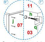
Ponga el mueble boca abajo y corrobore que quede en perfecta escuadra. Proceda a clavar la pieza 07 al mueble mediante los herrajes j. Coloque en las piezas 02 y 03 los herrajes q, fije el mueble a la pared
