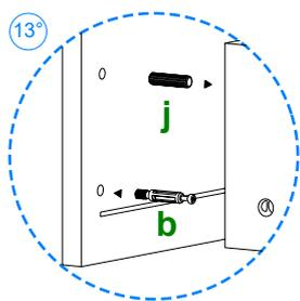
Coloque la pieza **09** sobre el piso y atornille 2 herrajes **b**. Coloque 1 herrajes **j** en cada pieza **02** como se indica.
