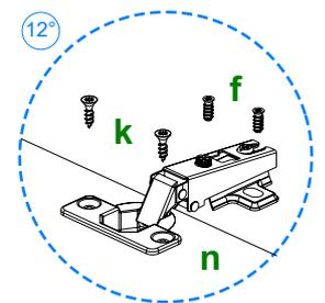
Coloque en la pieza **03**, 2 Partes Base del herraje **n** con 4 herrajes **f**. Coloque en la pieza **10**, 2 Partes Bisagra del herraje **n** con 4 herrajes **k**. Posicione la pieza **10** junto a la pieza **03** ensamble la bisagra y ajuste el tornillo de fijación de la misma.
