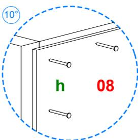
Ponga el mueble boca abajo y corrobore que quede en perfecta escuadra. Proceda a clavar la pieza **08** al mueble mediante los herrajes **h**.
