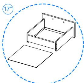
Deslice entre las ranuras la pieza **07** hasta hacer tope y únala a la pieza **11** mediante herrajes **h**.
