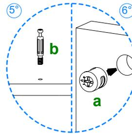
Atornille en la pieza **04** 3 herrajes **b**, en la pieza **05** 7 herrajes **b** y en la pieza **03** 4 herrajes **b**.
