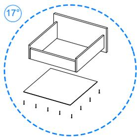
Proceda a clavar la pieza **09** al ensamble anterior mediante los herrajes **j**.
