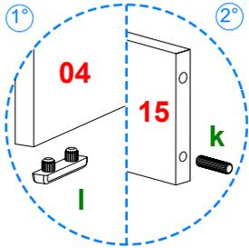
1° Coloque en la pieza 03 y 04 2 herrajes l como se indica. Coloque en la pieza 05, 06 y 07 4 herrajes k. Coloque en la pieza 15 2 herrajes k.
