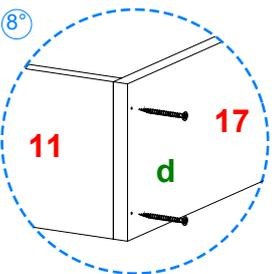
8° Posicione las piezas 05, 06 y 07 como se ilustra en la grafica, luego posicione el ensamble en las piezas 17 y 16. Atornille entre las pieza 08 y 17 la pieza 11 con 4 herrajes d como se indica.
