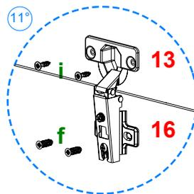
11° Coloque en la pieza 16, 2 Partes Base del herraje n con 2 herrajes f. Coloque en la pieza 13, 2 Partes Bisagra del herraje n con 2 herrajes i en cada una.
