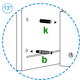
Coloque la pieza **10** sobre el piso y atornille 2 herrajes **b**. Coloque 1 herrajes **k** cada pieza **02** como se indica.
