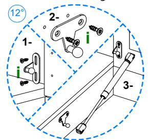
1- Atornille en la pieza 08 1 pieza Soporte fijación divisorio con 2 herrajes i. 2- Atornille en la pieza 13 1 pieza Soporte fijación tapa con espejo con 2 herrajes i. 3- Coloque en las piezas Soporte fijación divisorio y Soporte fijación tapa con espejo el Pistón como se indica.
