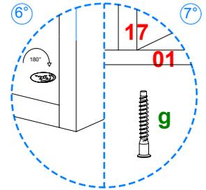
6° Posicione las piezas 08 y 17 con la pieza 14, luego gire los herrajes a hasta que que la flecha señale el sentido. Atornille por detras con 2 herrajes g. Posicione la pieza 01 entre las piezas 03 y 04, luego atornille con 4 herrajes g. Atornille por debajo de la pieza 01 las piezas 08 y 17 4 herrajes g.
