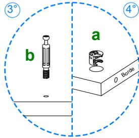
3° Atornille en las piezas 14 6 herrajes b como se indica. Atornille en las piezas 03 y 04 3 herrajes b. Coloque en las piezas 03, 04, 08, 15 y 17 2 herrajes a con la flecha hacia el borde. Coloque en la pieza 16 8 herrajes a con la flecha hacia el borde.
