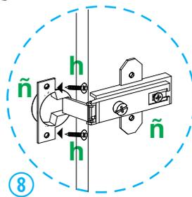
8 Posicione la pieza 12 en la pieza 04, fijando los herrajes ñ con 2 herrajes h cada uno. Repita colocando las piezas 11 en piezas 03 y 05.
