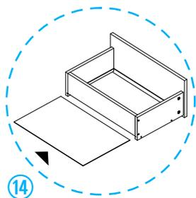
Deslice entre las ranuras la pieza **Fondo Cajón** hasta hacer tope y únala a la pieza **Puntera Cajón** mediante herrajes **i**.
