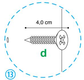
Atornille con 4 herrajes **d** la pieza **Puntera Cajón**, al ensamble anterior.
