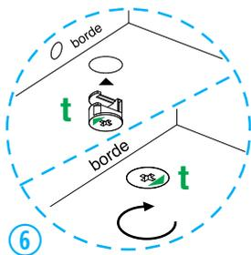
6 Coloque 2 herrajes **t** en la pieza **12** con la flecha hacia el borde. Posicione la pieza **12** por debajo de la pieza **05** y gire los herrajes **t** hasta que la flecha señale el sentido contrario.
