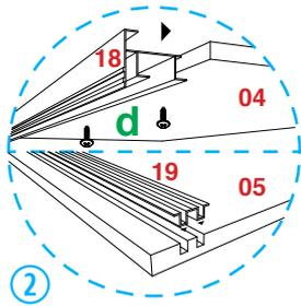
2 Coloque en la pieza **04** la pieza **18** y fije con 4 herrajes **d**. Coloque en la pieza **05** las 2 piezas **19** como se indica.
