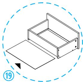
Deslice entre las ranuras la pieza 16 hasta hacer tope y únala a la pieza 13 mediante herrajes **n**.
