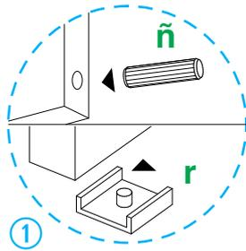
1 Coloque en las piezas **06** y **07** 2 herrajes **ñ** en cada borde. Coloque en la parte inferior de las piezas **01** y **02**, 2 herrajes **r** y 1 herraje **r** en las piezas **06** y **07** en el medio y asegúrelos con herrajes **n**.
