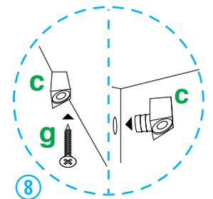
8 Coloque en la parte superior de las piezas **01** y **02** un herraje **c**. Atornille la pieza **04** a través de los herrajes **c** con herrajes **f**. Coloque en las piezas **06** y **07** un herraje **c** en cada una. Atornille la pieza **12** por debajo a través de los herrajes **c** con herrajes **g**.
