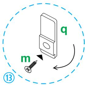
13 Coloque las piezas 11 en el mueble. **UNA VEZ YA COLOCADAS,** gire y atornille con herrajes m, los herrajes q, como se indica.
