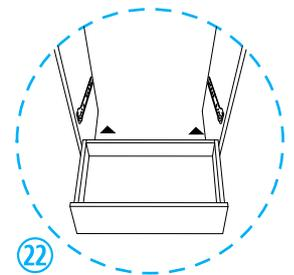
Coloque los cajones ya armados en el mueble terminado
