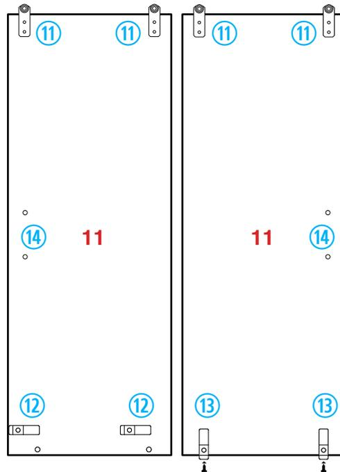
Las puertas se "cuelgan" del perfil del techo. La rueda tiene que encastrar en una de las "j" que tiene ese perfil. Luego se le coloca la traba plástica. Abajo se giran los guías plásticas y calzan adentro del perfil aluminio inferior.
