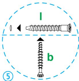
5 Fije la pieza **03** entre las piezas **04** y **05** con herrajes **l**. Atornille 2 herrajes **b** por debajo de la pieza **05**.
