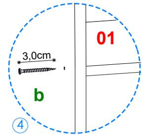
④ Posicione la pieza **01** entre la pieza **03** y **04** y luego atornille con 4 herrajes **b**.
