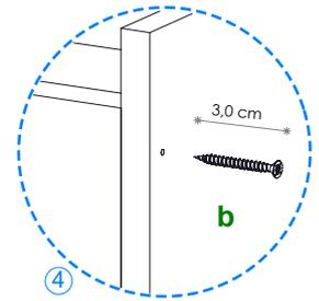
④ Atornille 4 herrajes **b** en la pieza **puntera de cajón**, al ensamble anterior
