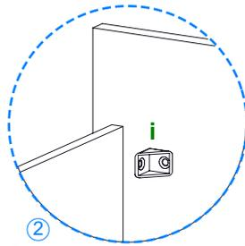
② Posicione 2 herraje **i** en cada lado de la pieza **frente de cajón** y entre **costado de cajón**. como se indica.
