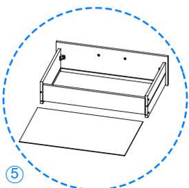
⑤ Deslice entre las ranuras la pieza **fondo de cajón** Hasta hacer tope y unala a la pieza **puntera de cajón** mediante herrajes **d**.
