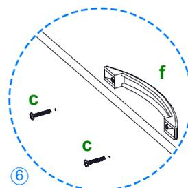
⑥ Coloque en la pieza **frente de cajón** el herrajes **f** con 2 herrajes **c**. repita el armado para todos los cajones y coloquelos en el mueble.
