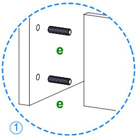
① Coloque en pieza **costado de cajón** 2 herrajes **e** en cada una, y despues únala a la pieza **frente de cajón**
