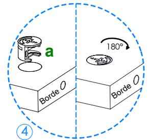
4 Coloque 4 herrajes **a** en la pieza **01**. Coloque 2 herrajes **a** en la pieza **09**. Posicione las piezas **01** y **09** entre las piezas **02** y **03**, gire los herrajes **a** hasta que la flecha indique el sentido contrario.
