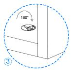
Posicione por encima de la pieza 03 la pieza 01, gire los herrajes a hasta que la flecha señale el sentido
