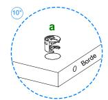
Coloque en la pieza 13, 16 y 19 4 herrajes a con la flecha hacia el borde. Posicione la pieza 16 las piezas 13 y 19, gire los herrajes a hasta que la flecha señale el sentido opuesto.
